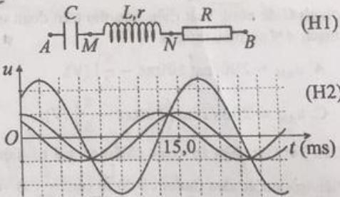
Câu 40: Đặt điện áp xoay chiều vào hai đầu đoạn mạch  $AB$  như hình H1. Hình H2 là đồ thị biểu diễn sự phụ thuộc của điện áp giữa hai đầu đoạn mạch  $AB$ , đoạn mạch  $MN$  và đoạn mạch  $NB$  theo thời gian  $t$ . Điều chỉnh tần số của điện áp đến giá trị  $f_0$  thì trong đoạn mạch  $AB$  có công hưởng điện. Giá trị  $f_0$  gần nhất với giá trị nào sau đây?
