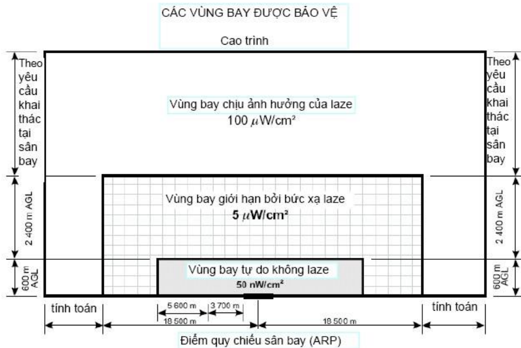
Hình IV.13. Các vùng bay được bảo vệ với độ bức xạ Laze max nhìn thấy
