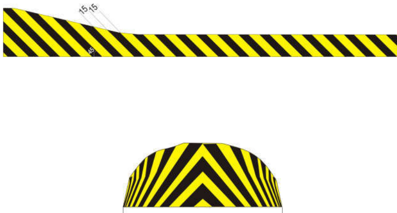
Hình G.64 - Sử dụng vạch 8.1 trên đảo phân làn tại trạm thu phí - Mẫu 2
